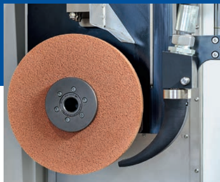
Positionnement de la buse de refroidissement commandée par commande numérique et nettoyage à haute pression intégré de la meule
