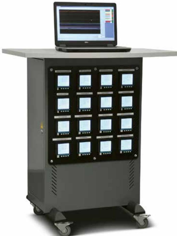
Diese Messvorrichtung ist in Zusammenarbeit mit der ETH Zürich/Inspire entstanden. Es können bis zu 16 elektrische Kanäle und ein Luftdruckkanal ausgewertet werden. Die Aufzeichnung erfolgt automatisch und als Resultat entsteht ein Diagramm wie oben abgebildet.
