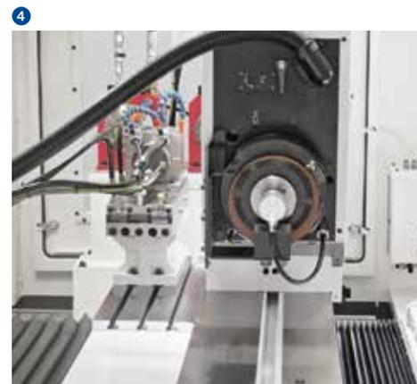
L'usinage des cônes peut se faire de deux manières: soit au moyen d'une table de travail à pivotement manuel sur un angle maxi de 21° ou de 31° (uniquement sur la S110) ou au moyen d'un dressage et d'une rectification coniques avec la table de travail droite.
