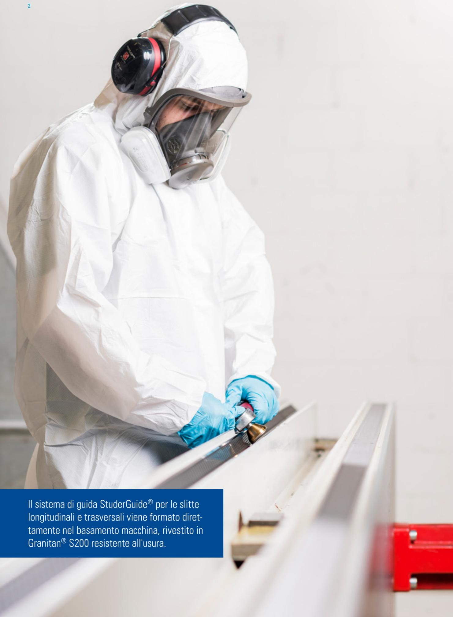
Il sistema di guida StuderGuide® per le slitte longitudinali e trasversali viene formato direttamente nel basamento macchina, rivestito in Granitan® S200 resistente all'usura.
